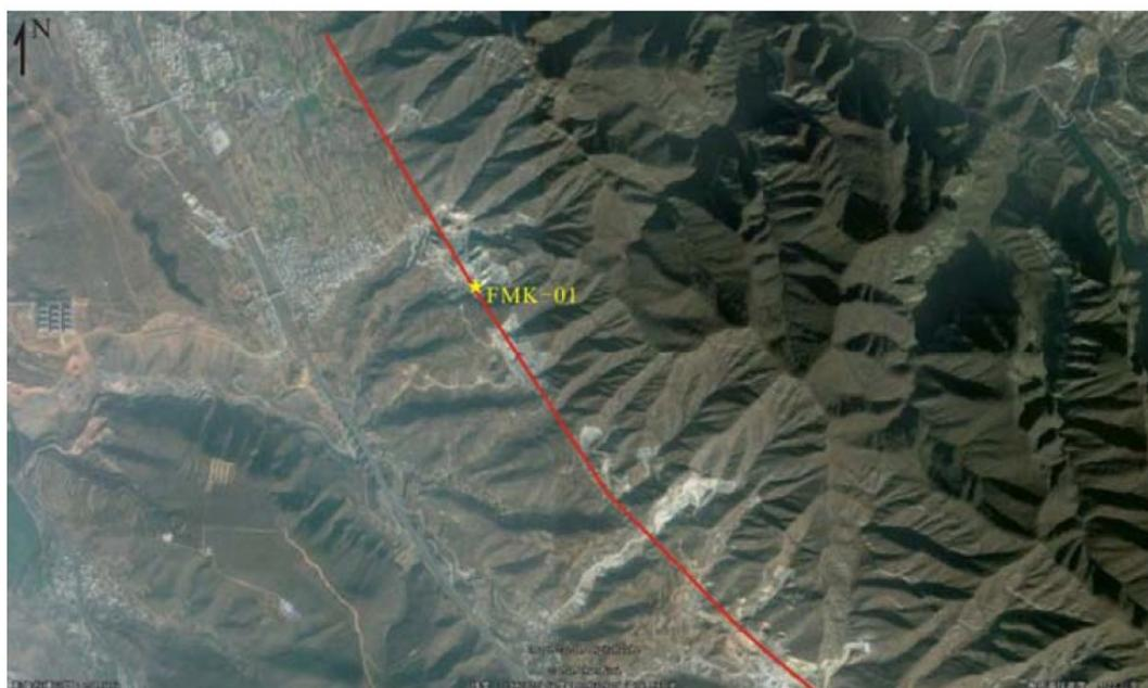
图 3.3.14-1 封门口断裂影像解译(北京勘察技术工程有限公司, 2015)
