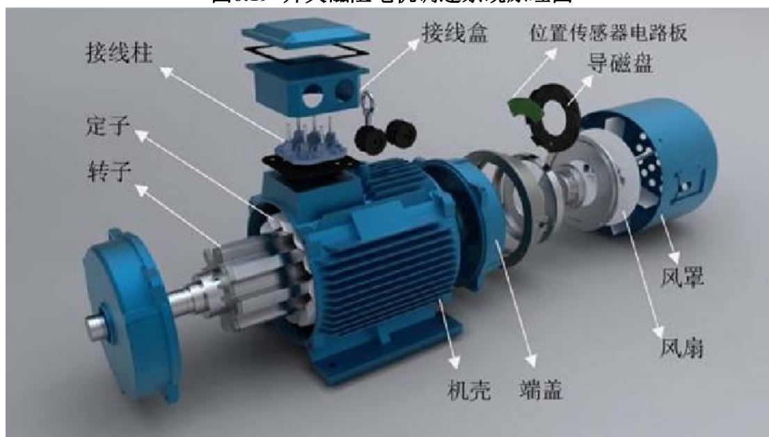
图6.20 开关磁阻电机
